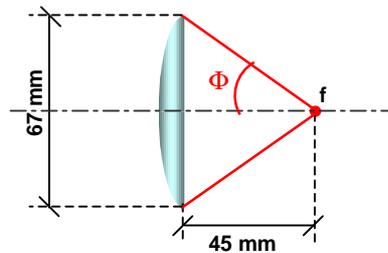
**Figure 4. 13** Lens deviation angle.
