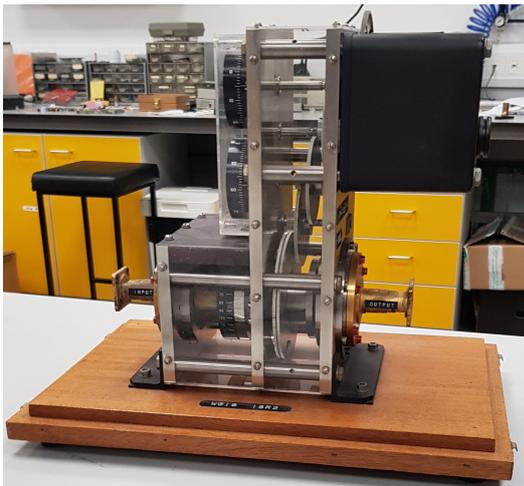
Fig. 2: Atenuador de veleta rotatoria para WR62 disponible en National Physical Laboratory.
